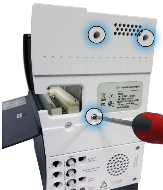
Abb.15 Entfernen Sie die Rückwand, indem Sie die drei Schrauben lösen.
