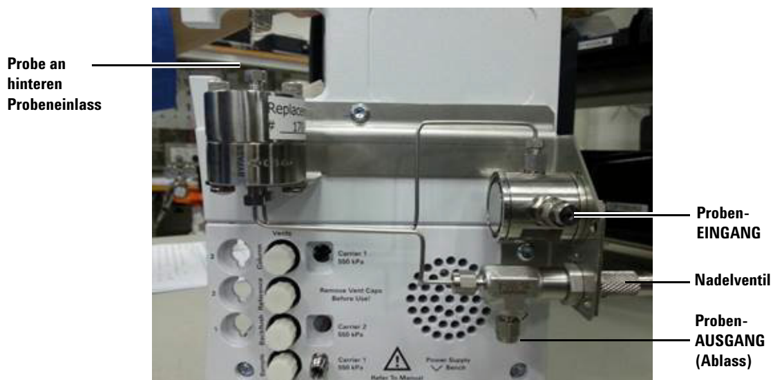
Abb.22 Druckreglerbaugruppe G3581-S0003 installiert
