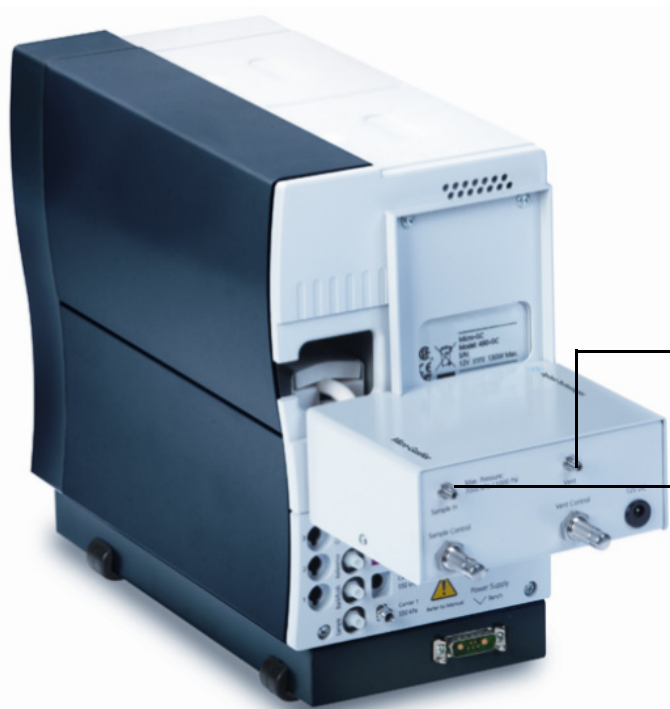
Abb.18 Probenleitungs- und Entlüftungsleitungsanschluss des Mikro-Vergasers.
