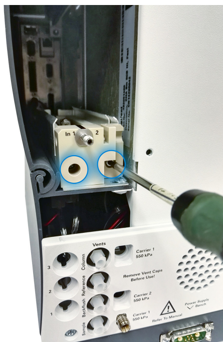
Abb.16 Entfernen Sie den PEEK-Block, indem Sie die zwei Schrauben lösen.
