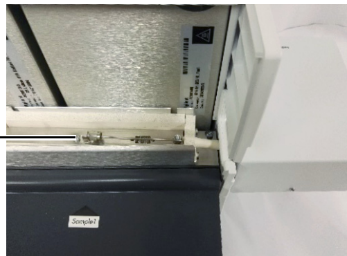
Abb.17 Installieren Sie Rückwand und Mikro-Vergaser und schließen Sie die Probenleitung des Mikro-Vergasers mit einem 1/16-Zoll Swagelok-Anschluss an den internen Probeneinlass an.
