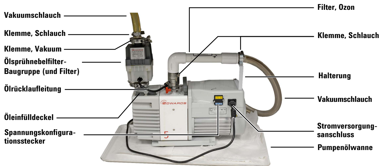
Abbildung 4 RV5-Vakuumpumpe
