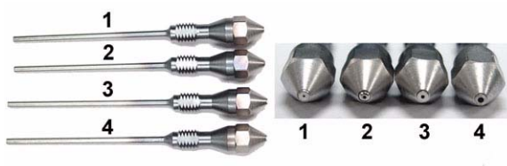
Figura 2 Chorros capilares adaptables
