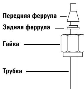
Рис. 8 Гайки Swagelok и феррулы
