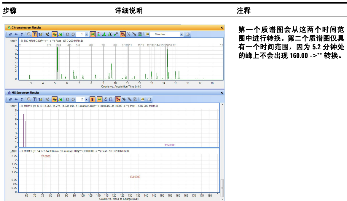
图 22 从色谱图中的两个不同范围提取的两个平均质谱图
