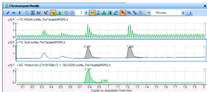
図 23 ピーク数を制限して積分された TIC MS と MS/MS のクロマトグラム
