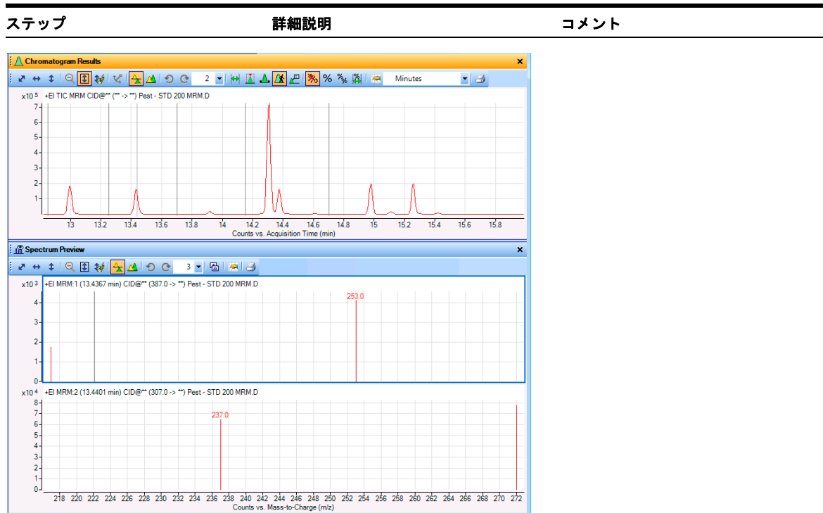
図 56 「クロマトグラムを進める」を使用して13.43分のピークの2つのMRMスペクトルを表示する
