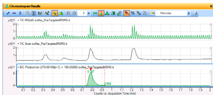
図 21 元の TIC と MS データの TIC、MS/MS データの EIC の比較
