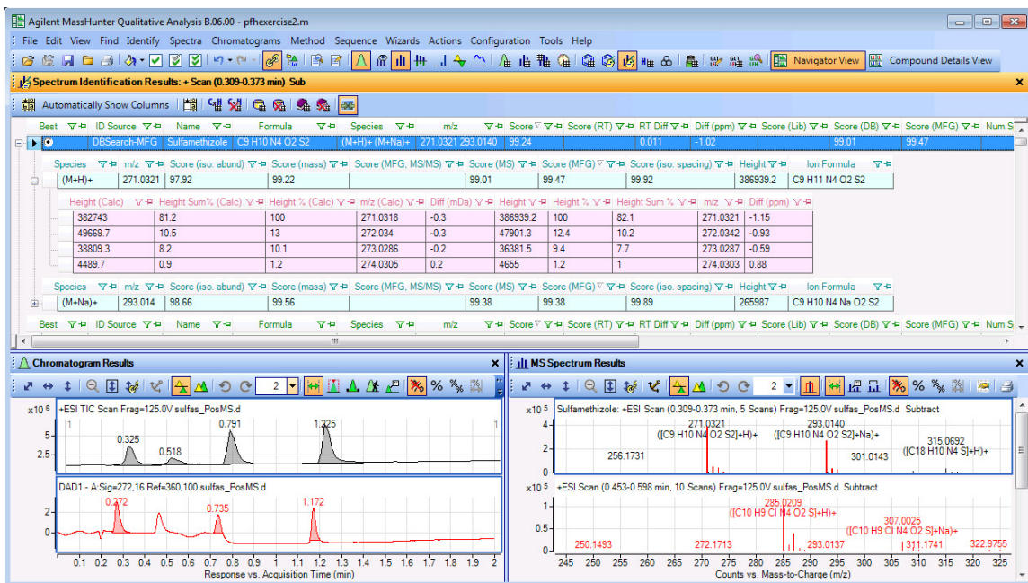
图 70 打开 sulfas_PosMS.d 数据文件时色谱图峰识别操作的结果
