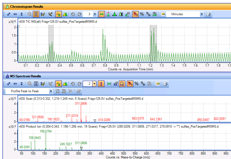
图 31 根据多个范围创建的平均 MS 和 MS/MS 质谱图。
