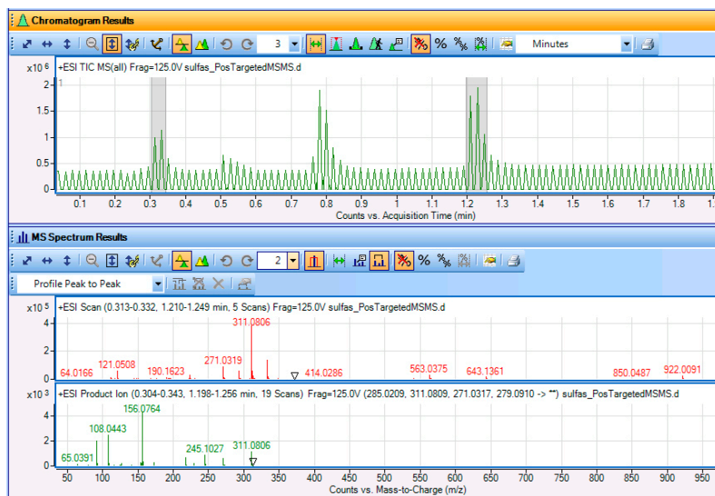
図 31 複数の範囲から作成された平均MSとMS/MSスペクトル
