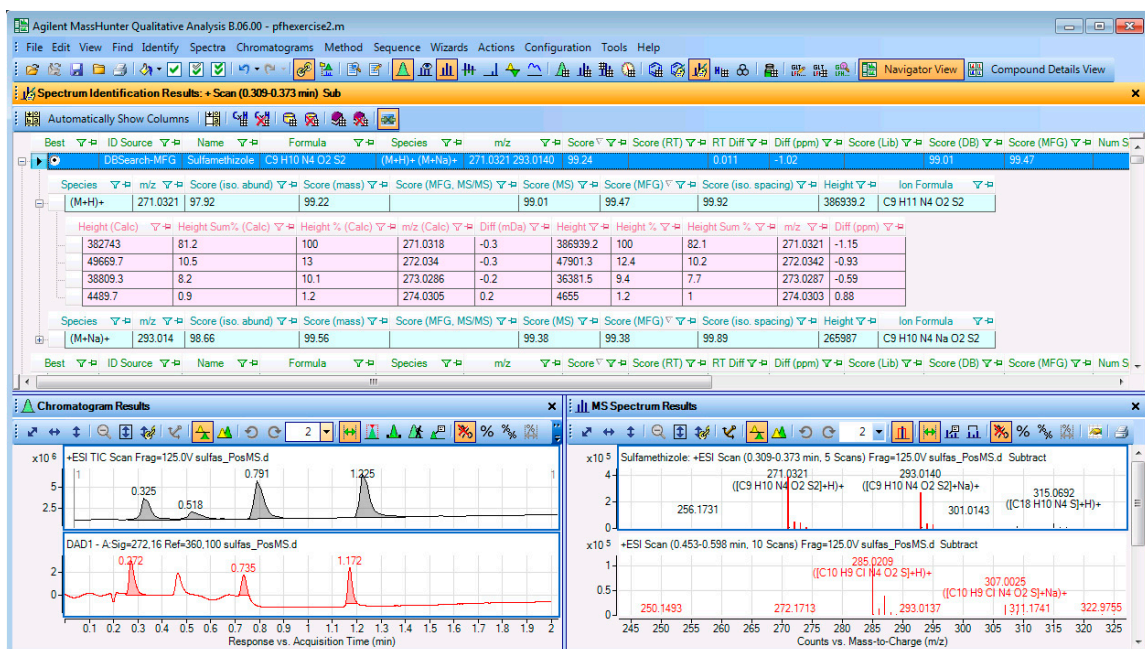
図 70 sulfas_PosMS.dデータファイルを開くときにクロマトグラムピーク調査処理をした結果
