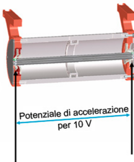
Figura 26 Progettazione della cella di collisione
