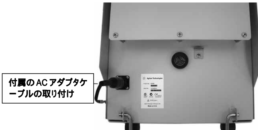
図8 電源ケーブルの取り付け
