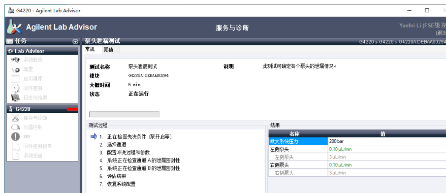
图 223 2D-LC 1290 二元泵的泵头泄漏测试
