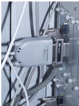
图 7 USB-GPIB 接口连接
