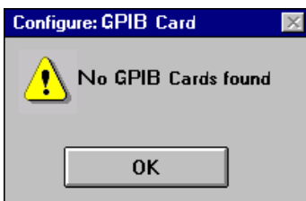
图 29 未检测到系统中的 GPIB 接口
