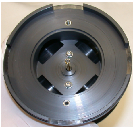
图 54 八极杆从锥孔体逆电流器中伸出
