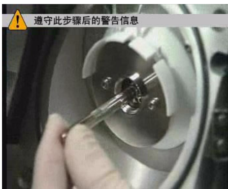
图 37 从去溶剂化组件中抽出毛细管
