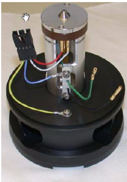
图 62 重新组装的离子光学组件
