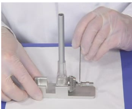
图 32 将雾化器安装到调整夹具中
