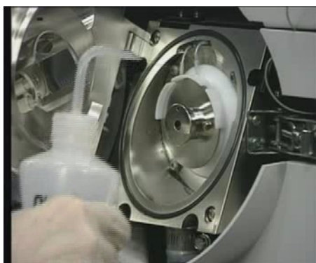
图 17 冲洗雾化护罩的周边区域
