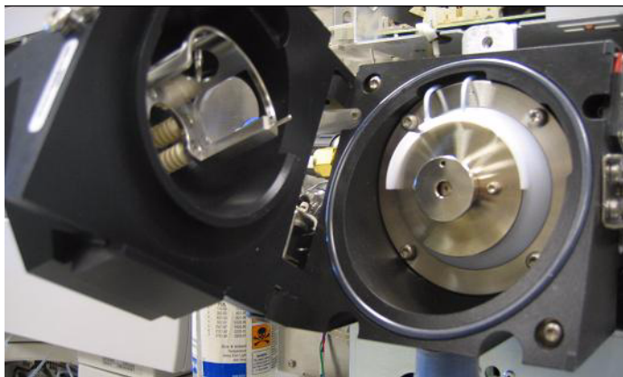
图 1 打开的电喷雾雾化室
