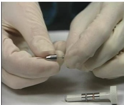
图 35 将新针装入套筒
