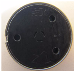
图 48 CDS 转子密封垫在其正确方向
