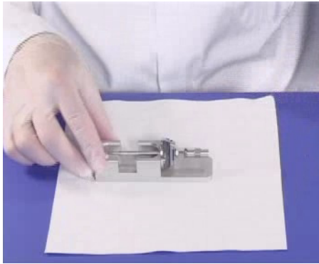
图 6 装在针支架中的电喷雾雾化器针
