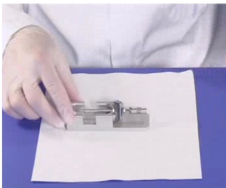
图 19 装在针支架中的电喷雾雾化器针
