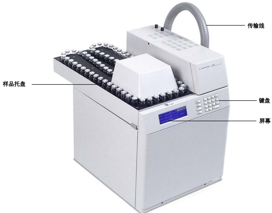
图 1 G1888 网络顶空进样器概览（仪器前端）
