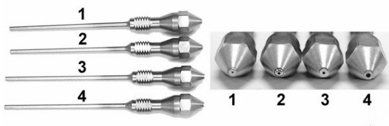
Рис. 2 Типы сопел для регулируемых фитингов капиллярной колонки
