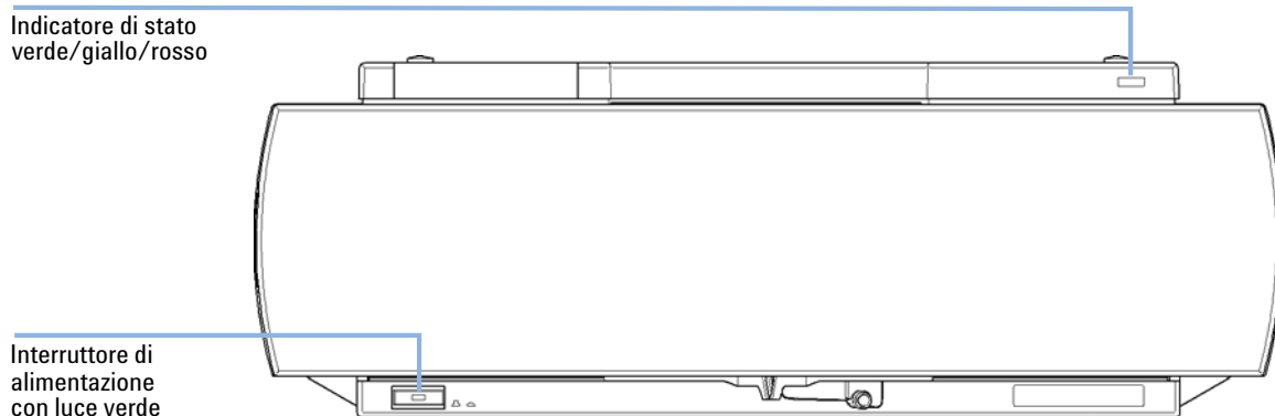
Figura 19 Vista frontale del comparto colonne termostato
