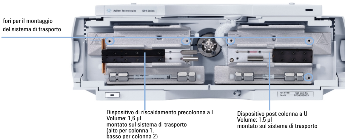
Figura 13 Punti di installazione per lo scambiatore di calore/dispositivi di raffreddamento
