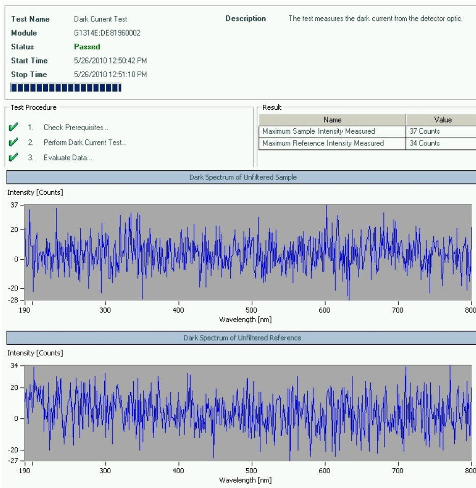
Figura 63 Test de corriente oscura con LabAdvisor de Agilent
