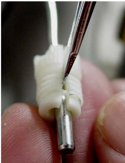
图 72 拆卸塑料接头
