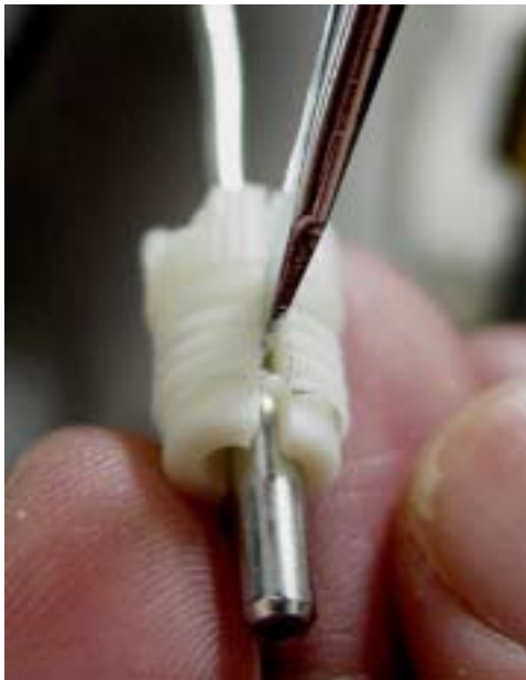
图 72 拆卸塑料接头
