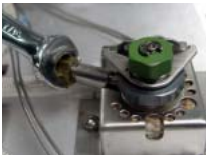
图 70 拧下 Swagelok 螺帽
