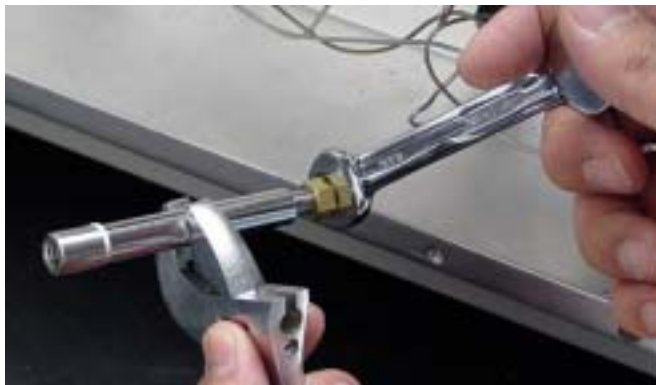
图 74 拆下 Swagelok 螺帽
