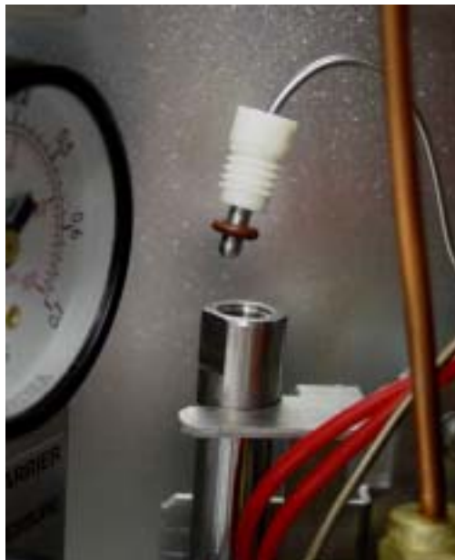
图 71 拆下塑料接头
