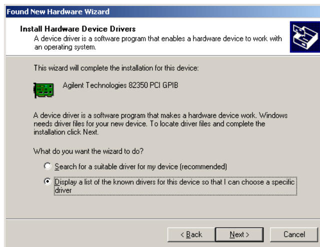
図 30 Hardware wizard: 実行するタスクの選択
