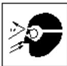
Direktes Hineinschauen in die Deuteriumlampe des Spektralphotometers kann zu Augenschäden führen. Schalten Sie die Deuteriumlampe immer aus, bevor Sie die Lampenblende auf der Seite des Gerätes öffnen.
