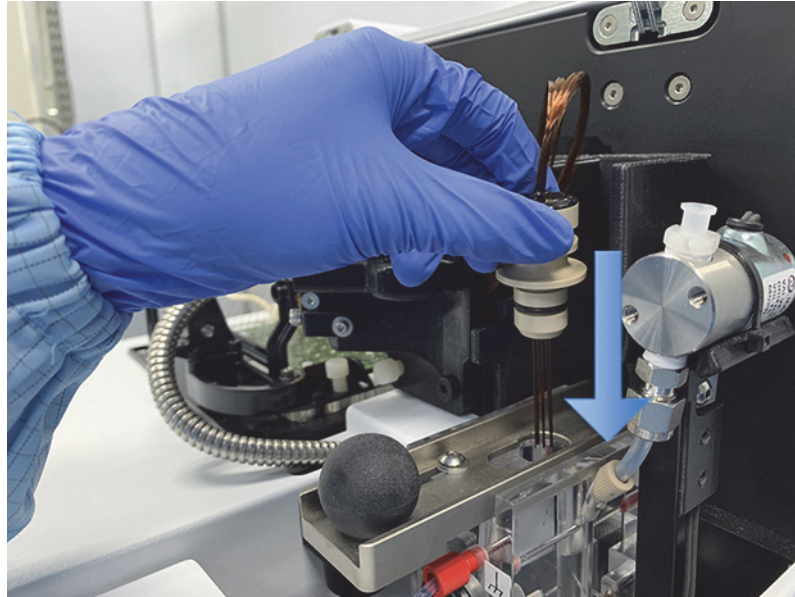
图 80 仪器顶部隔室 - 安装毛细管阵列束
