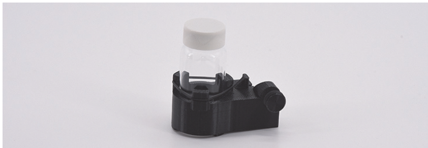
图 113 阵列轴杆储存装置，所示的瓶中无储存溶液
