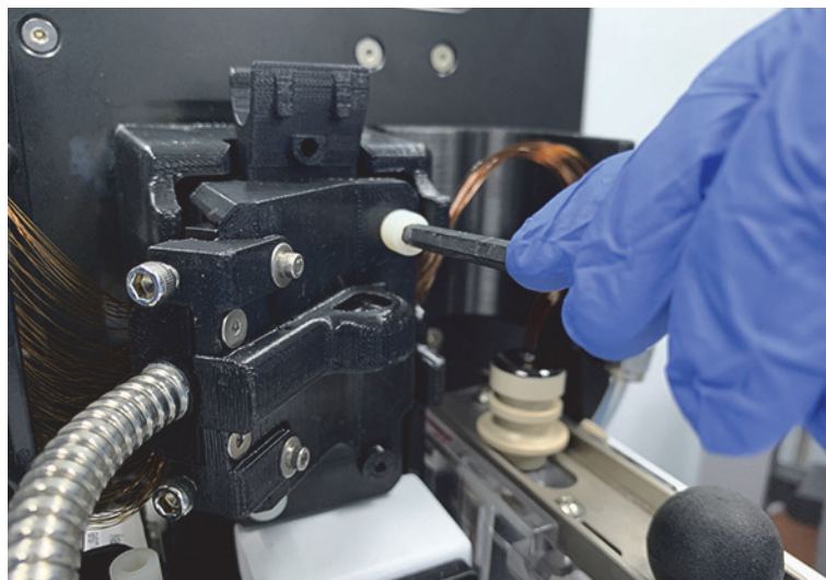
图 58 仪器顶部隔室 - 拧松导光板
