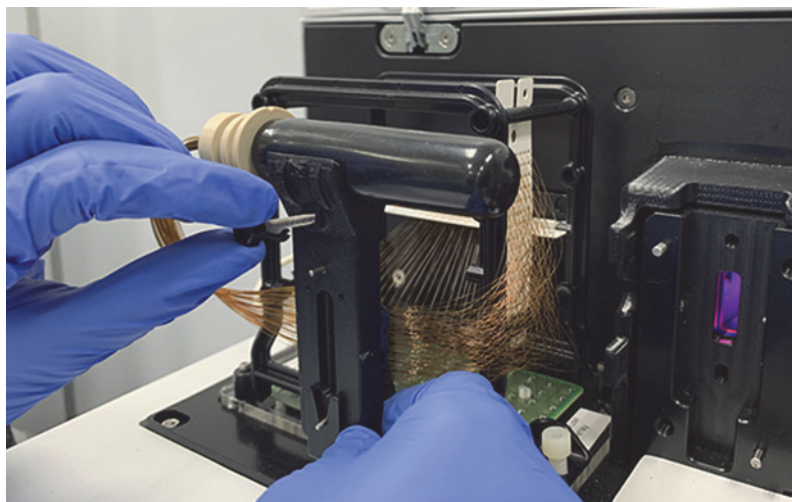
图 76 仪器顶部隔室 - 取下阵列窗口
