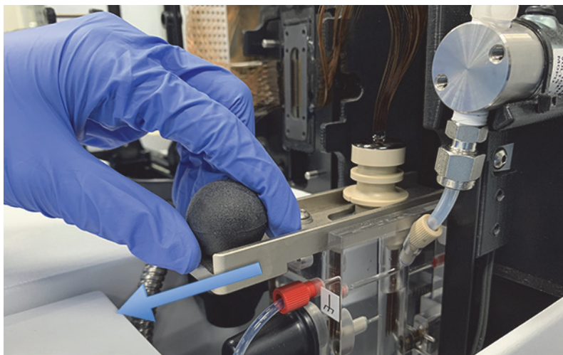
图 60 仪器顶部隔室 - 毛细管储液槽连接器滑块
