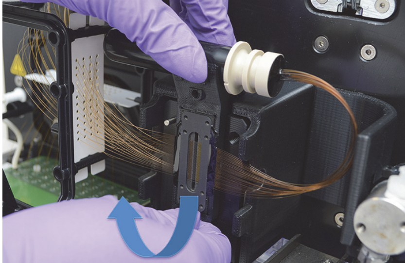
图 65 仪器顶部隔室 - 取下毛细管阵列窗口
