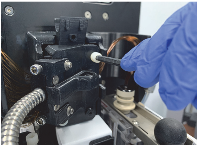
图 83 仪器顶部隔室 - 安装导光板
