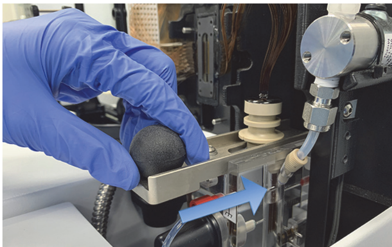
图 81 仪器顶部隔室 - 毛细管储液槽连接器滑块
