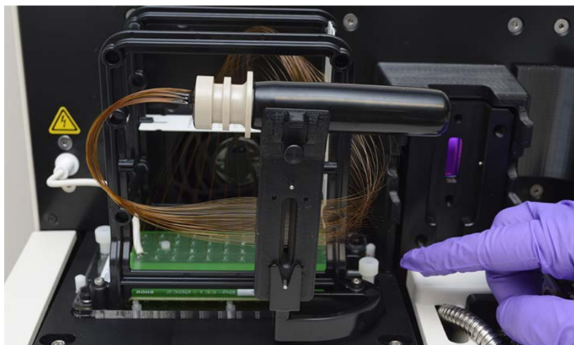
Afbeelding 69 Bovenste compartiment van instrument - bevestigen van bevestigingsschroef van array, op afbeelding gemarkeerd
