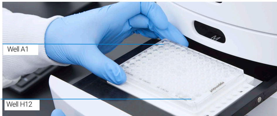
Afbeelding 9 Juiste oriëntatie bij het laden van 96-wells-marker- en monsterplaten voor een systeem met 12 capillairen
