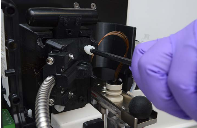
Afbeelding 77 Bovenste compartiment van het instrument – installatie van de lichtgeleider
