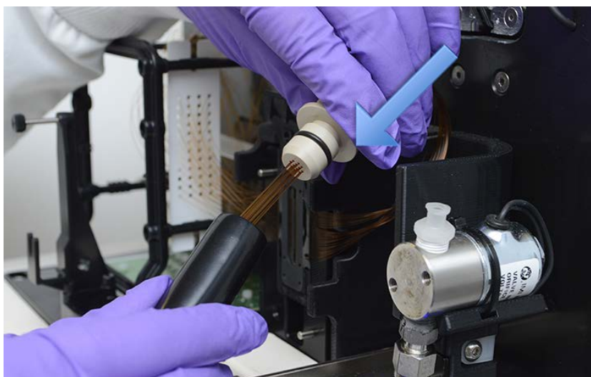
Afbeelding 57 Bovenste compartiment van het instrument – beschermkap plaatsen
