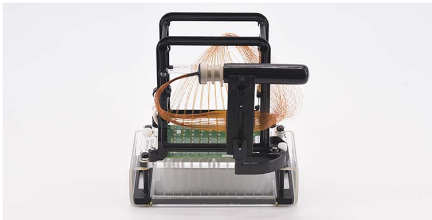
Afbeelding 102 Array-dockingstation met geplaatste capillairen-array
