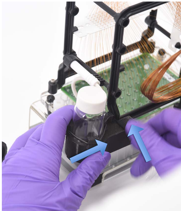
Afbeelding 104 Plaatsen van het array-spindelopslagapparaat
