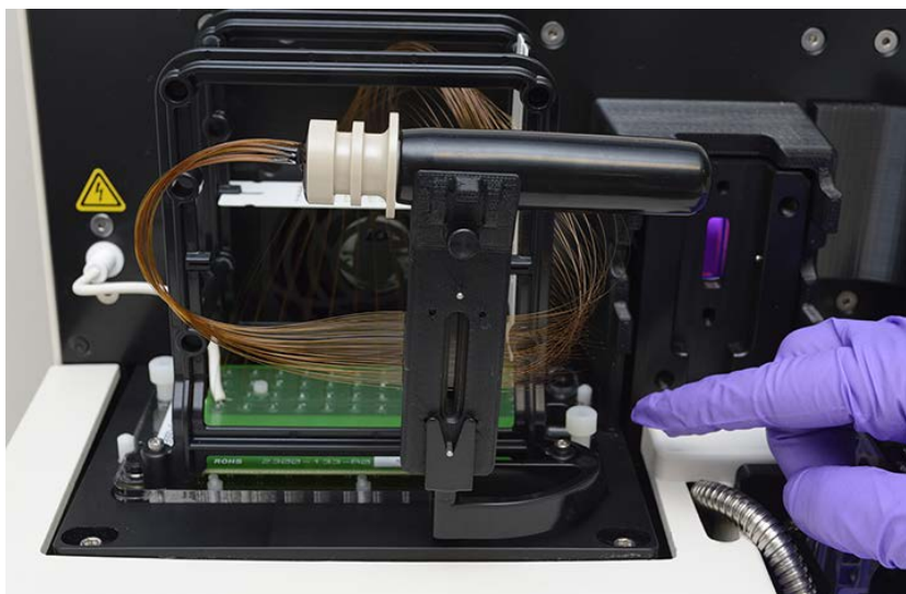
Figura 61 Comparto superiore dello strumento: rimozione delle viti di fissaggio dell'array
