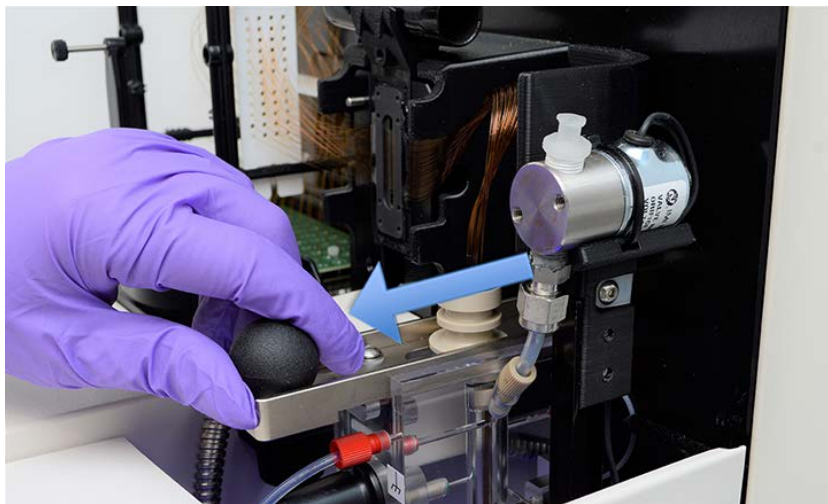
Figura 54 Comparto superiore dello strumento: slitta del connettore del serbatoio dei capillari
