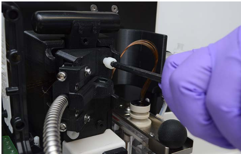
Figura 52 Comparto superiore dello strumento: svitamento della guida di luce
