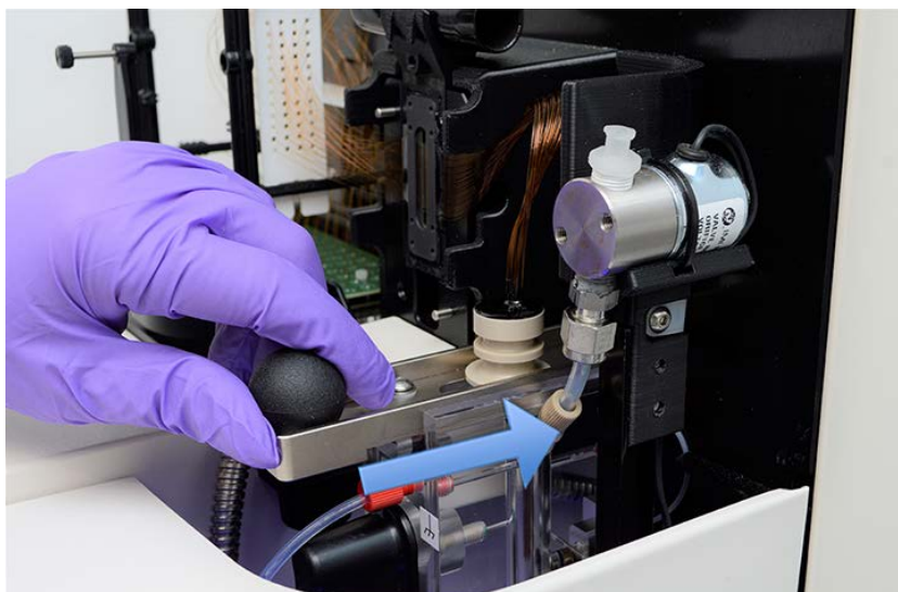
Figura 75 Comparto superiore dello strumento: slitta del connettore del serbatoio dei capillari
