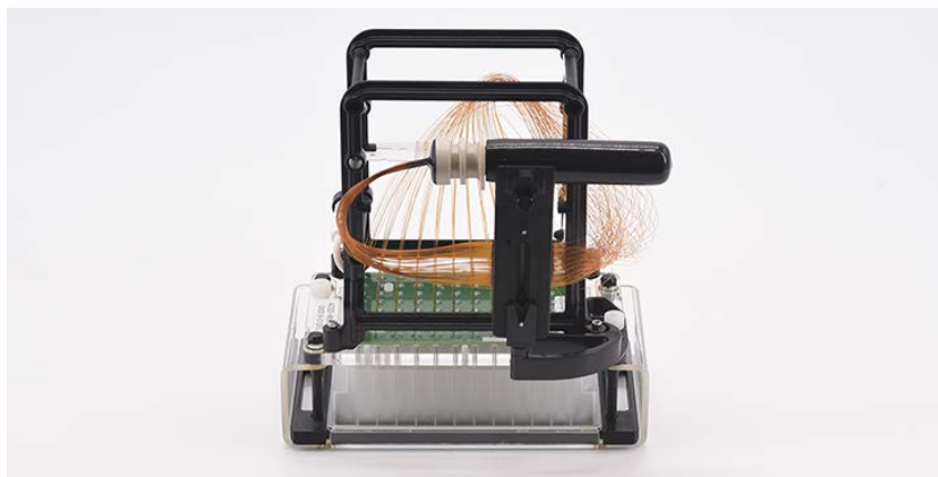
Figura 102 Stazione di alloggiamento dell'array con capillary array installato
