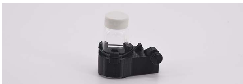
Figura 103 Dispositivo di conservazione del fuso dell'array; il vial dell'esempio non contiene soluzione di conservazione
