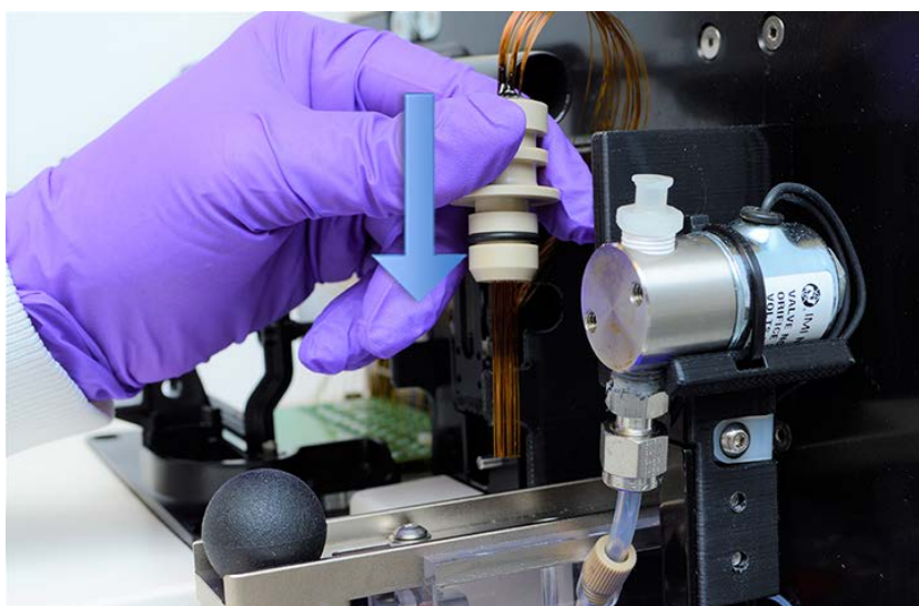
Figura 74 Comparto superiore dello strumento: installazione del fascio del capillary array
