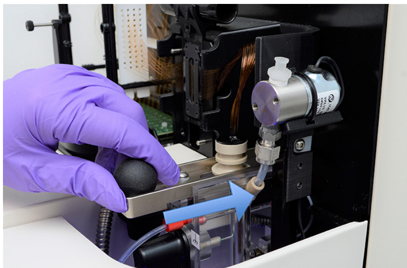
Figure 75 Compartiment supérieur de l'instrument – connecteur coulissant du réservoir des capillaires
