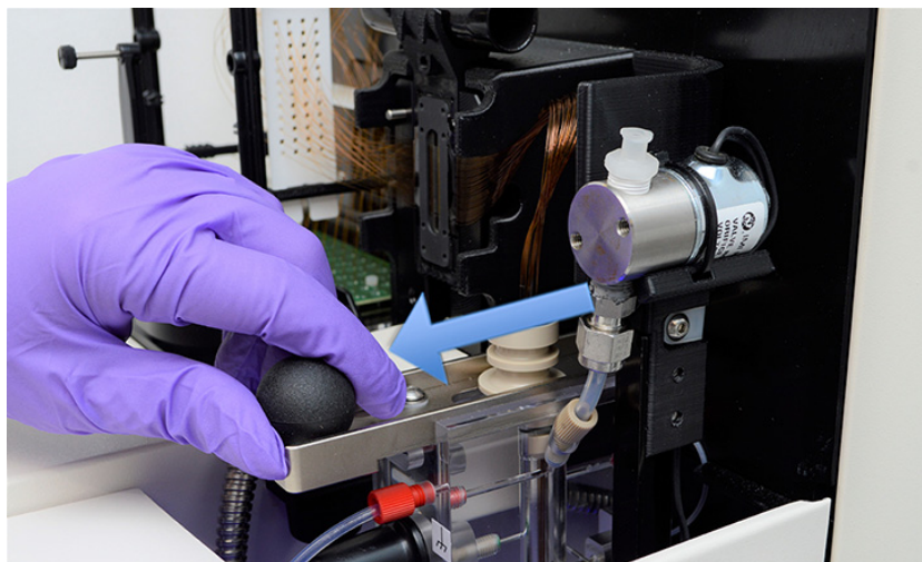
Figure 54 Compartiment supérieur de l'instrument – connecteur coulissant du réservoir des capillaires
