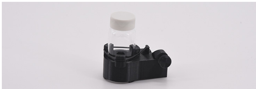
Figure 103 Dispositif de stockage du fuseau de l'array, avec un flacon vide de toute solution de stockage dans cet exemple
