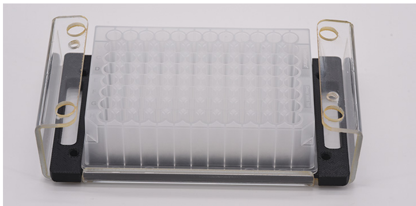
Figure 101 Station d'accueil d'array avec plateau à 96 puits profonds
