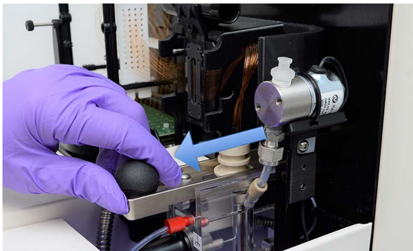
Figura 54 Compartimento superior del instrumento: elemento deslizante del conector del cartucho de capilares
