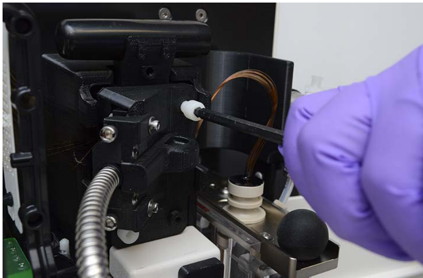
Figura 77 Compartimento superior del instrumento: instalación de la guía de luz
