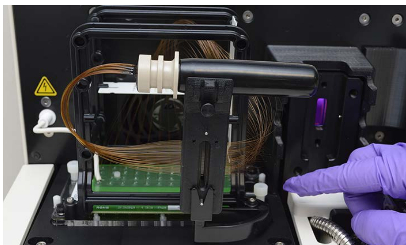
Figura 69 Compartimento superior del instrumento: colocación de los tornillos de sujeción del microarray (en la imagen se muestra uno de estos tornillos)
