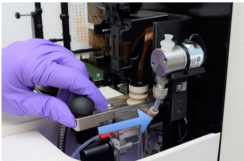
Figura 75 Compartimento superior del instrumento: elemento deslizante del conector del cartucho de capilares
