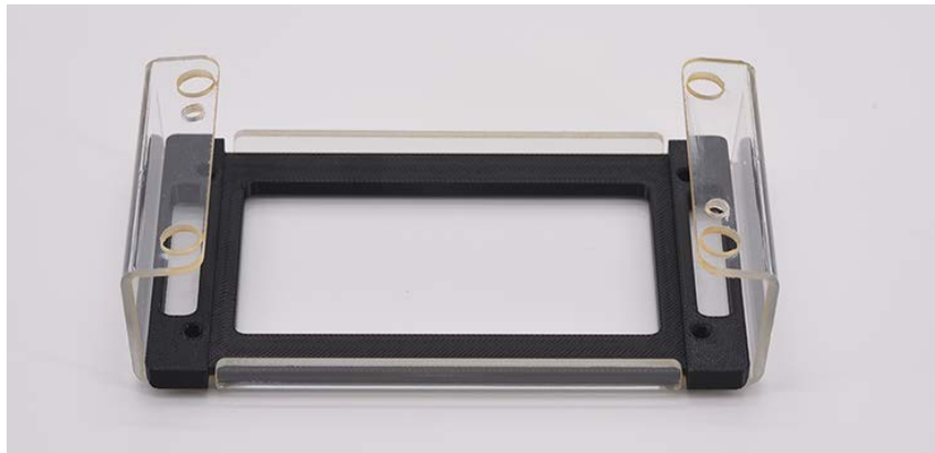
Figura 100 Estación de acoplamiento de microarrays con la base de la bandeja instalada
