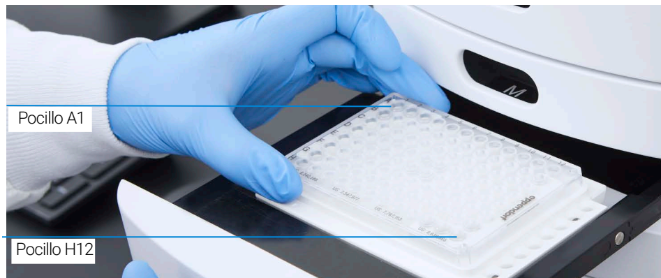
Figura 9 Orientación correcta para la carga de placas de 96 pocillos con marcadores y muestras en un sistema de 12 capilares
