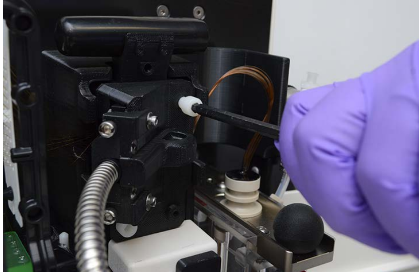
Abbildung 77 Oberes Gerätefach – Installation des Lichtleiters
