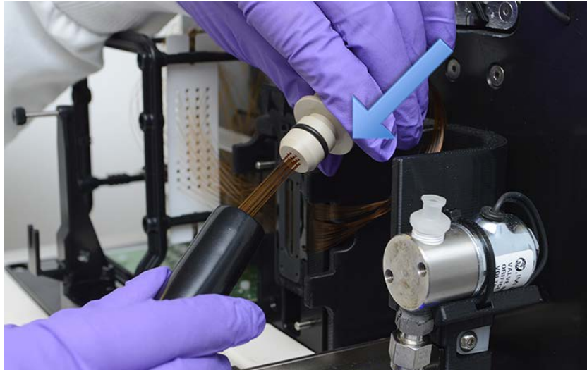
Abbildung 57 Oberes Gerätefach – Anbringung der Schutzhülle
