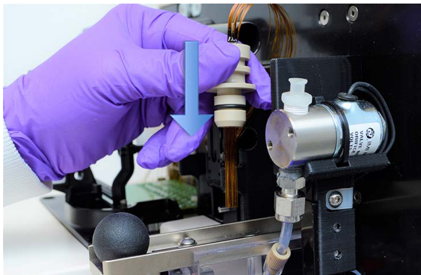
Abbildung 74 Oberes Gerätefach – Installation des Capillary Array-Bündels
