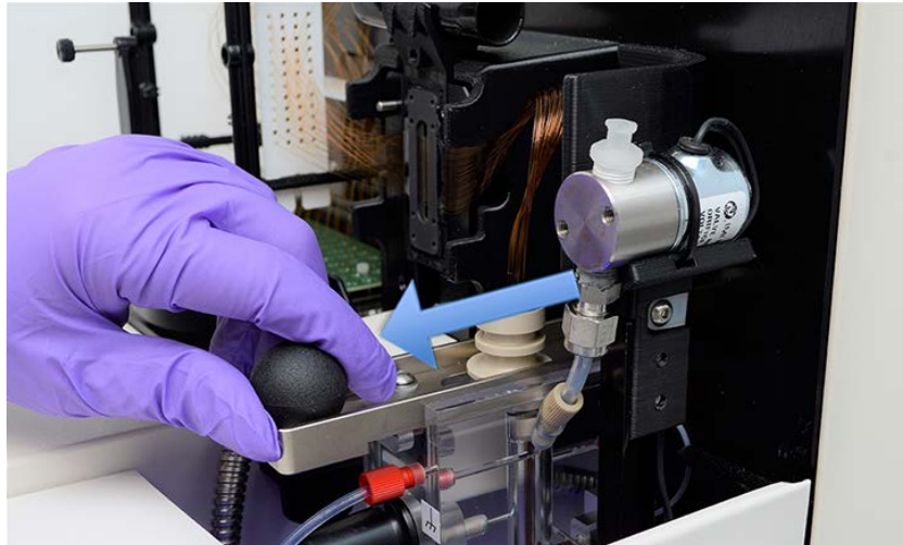
Abbildung 54 Oberes Gerätefach – Schiebekonnektor des Kapillarreservoirs
