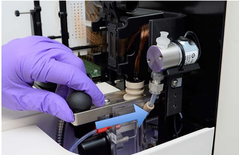
Abbildung 75 Oberes Gerätefach – Schiebekonnektor des Kapillarreservoirs
