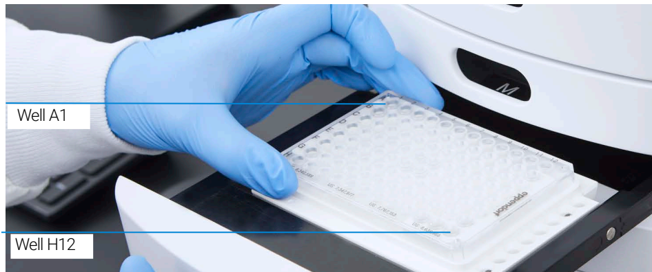
Abbildung 9 Korrekte Ausrichtung beim Beladen von Marker- und Proben-96-Wellplates für ein System mit 12 Kapillaren.
