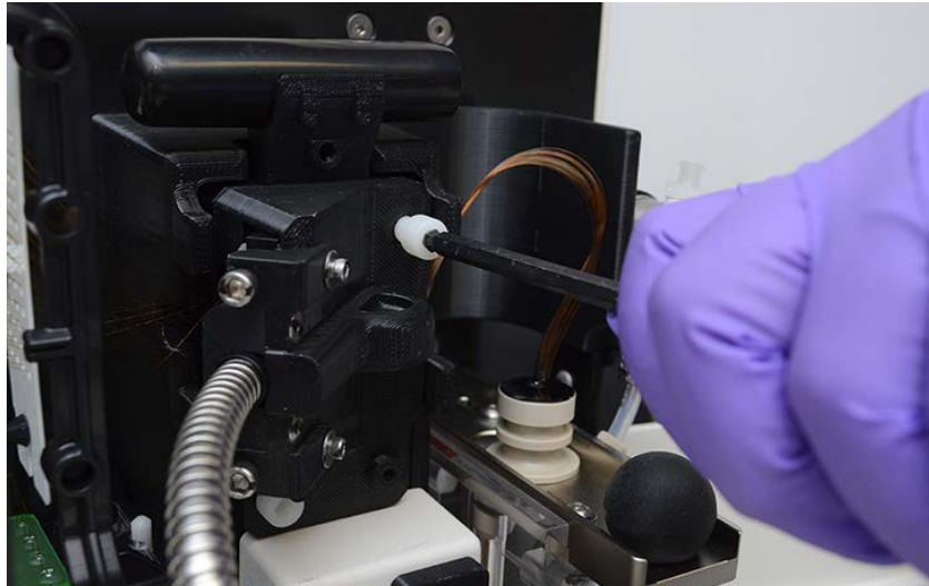
Abbildung 52 Oberes Gerätefach – Lichtleiter abschrauben
