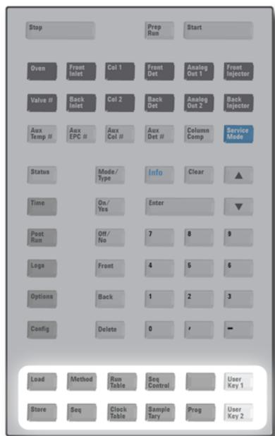
Ces touches servent à charger et à enregistrer des méthodes et des séquences localement sur le CPG. Elles ne permettent pas l'accès à des méthodes ou à des séquences stockées sur le système de données Agilent.
