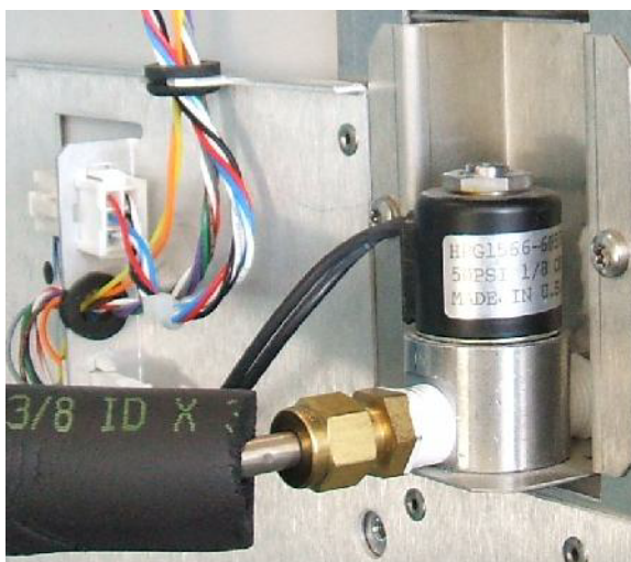
Figure 15 Connexions de la vanne de refroidissement cryogénique N 2
