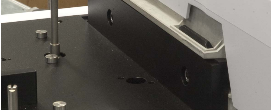
Figure 26 Retrait des vis du support de montage du châssis
