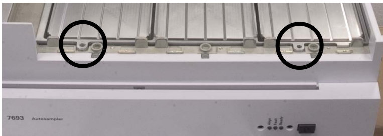
Figure 48 Installation de deux vis Torx T-20 pour fixer l'avant du module Peltier
