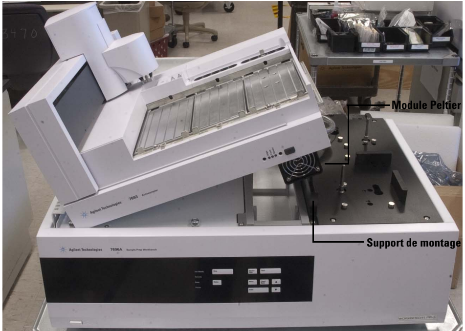
Figure 52 Installation du porte-échantillons en appui sur le châssis, module Peltier reposant sur le support de montage
