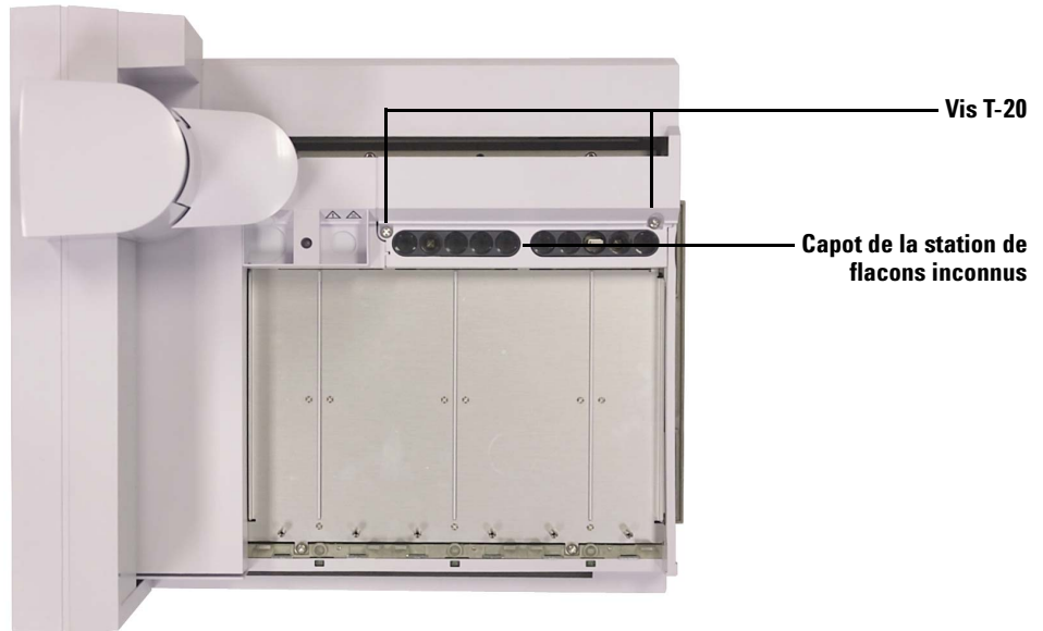
Figure 39 Retrait des vis et du capot de la station de flacons inconnus
