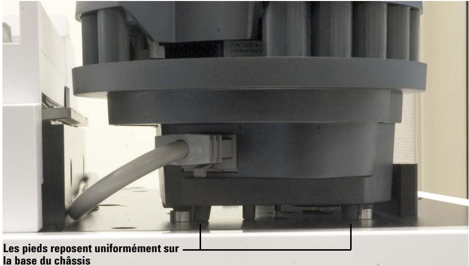
Figure 20 Installation de la tour avant sur le châssis.
