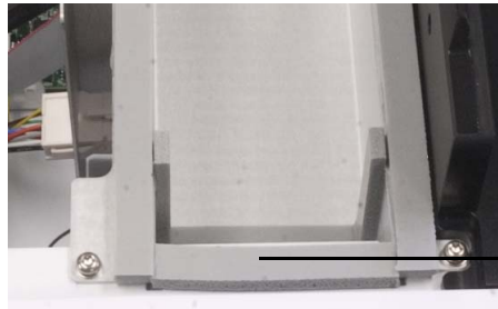
Figure 35 Installation de la mousse adhésive sur le châssis
