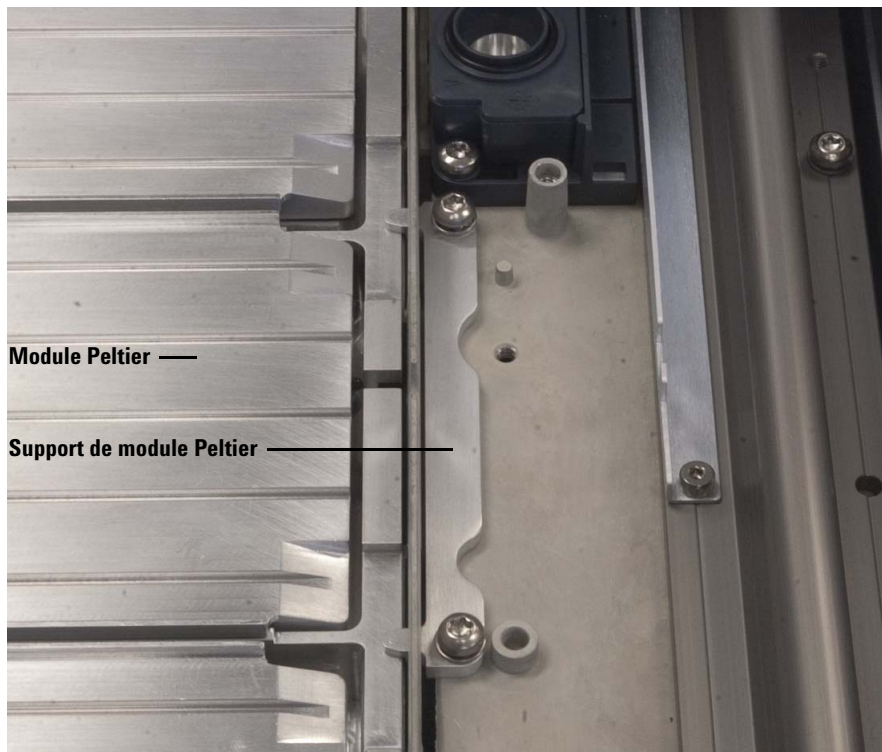
Figure 50 Fixation du module Peltier et de son support
