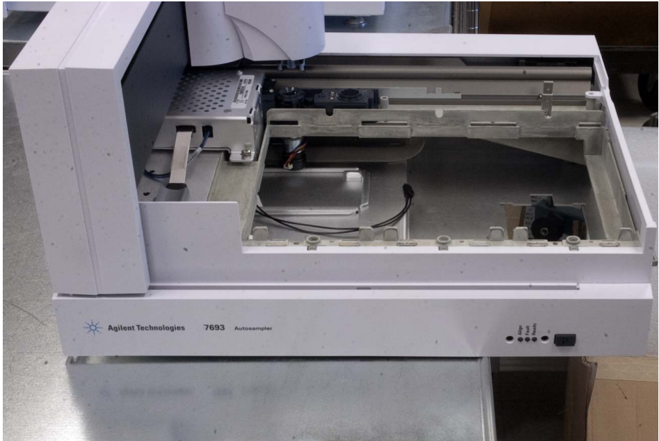
Figure 38 Installation du porte-échantillons au bord d'un établi ou d'une table
