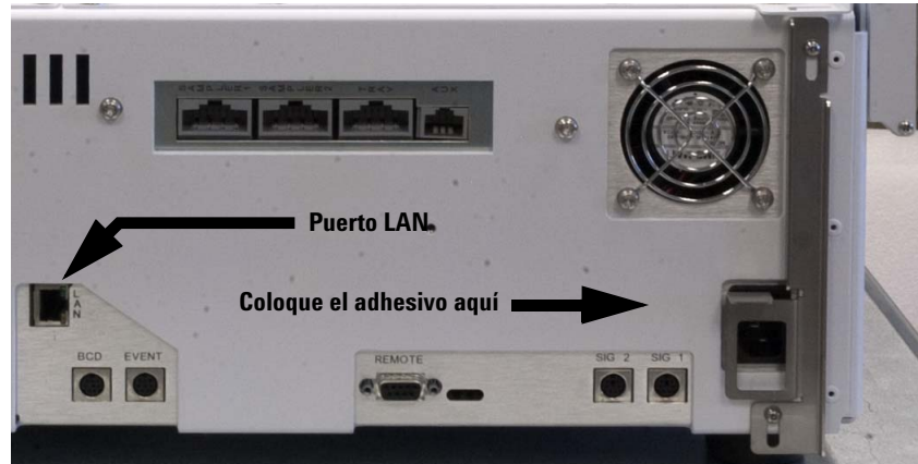
Figura 4 Adhesivo de voltaje y ubicación de puertos LAN
