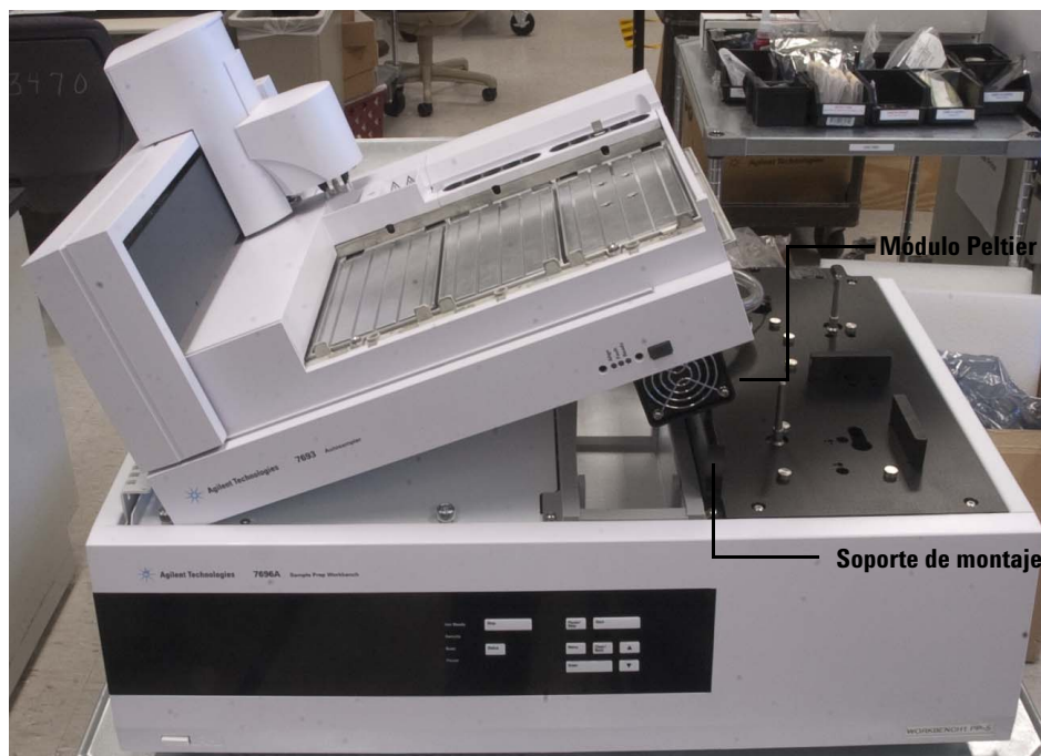
Figura 52 Colocación de la bandeja de muestras en la estructura principal con el módulo Peltier en el soporte de montaje
