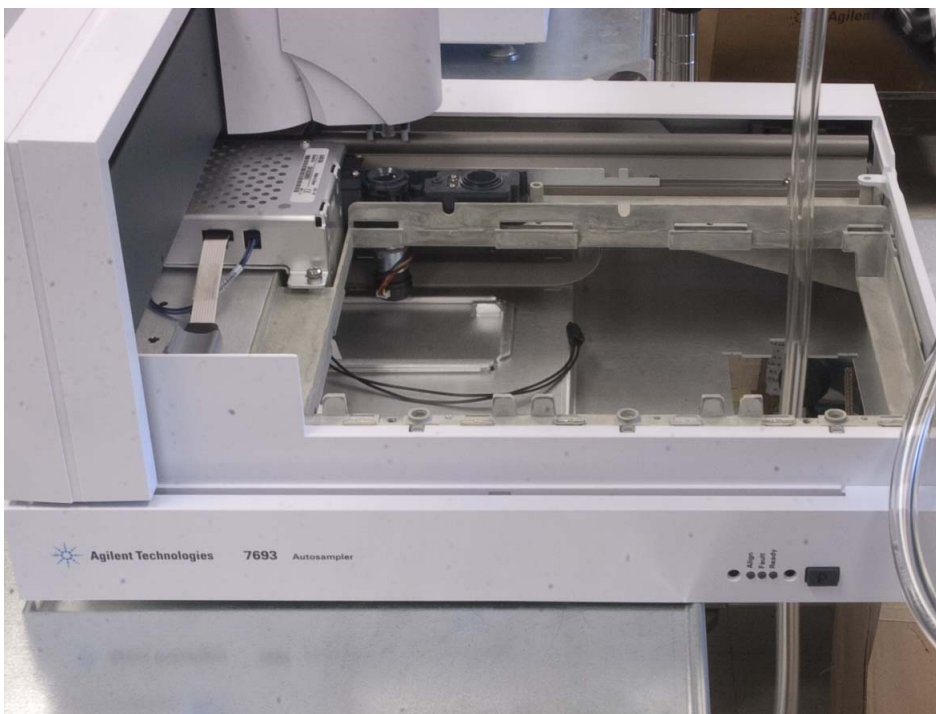
Figura 44 Pasar el tubo de drenaje por la abertura del accesorio
