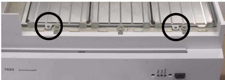
Figura 48 Instalación de dos tornillos T-20 Torx para sujetar la parte frontal del módulo Peltier
