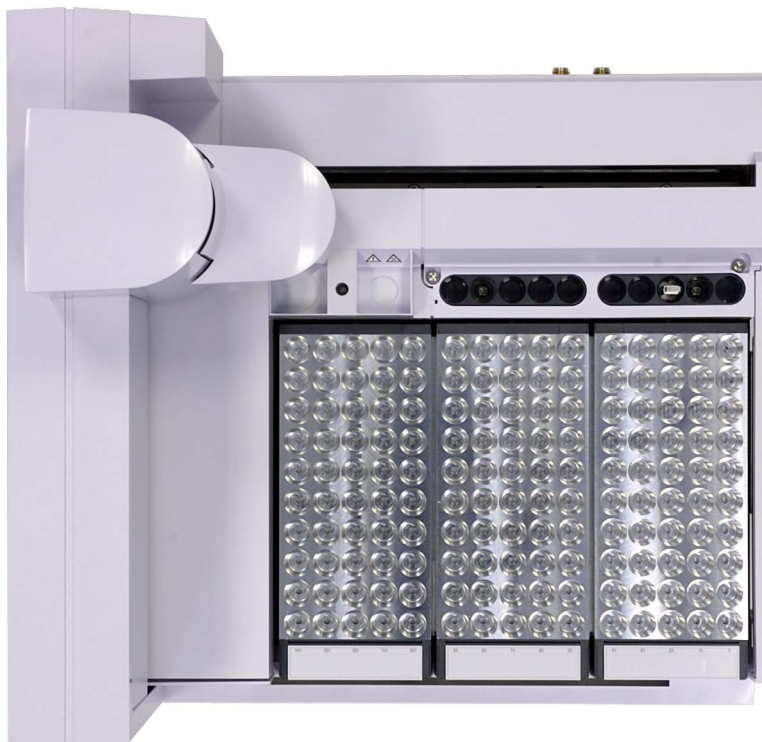
Figura 58 Gradillas de viales del módulo Peltier instaladas
