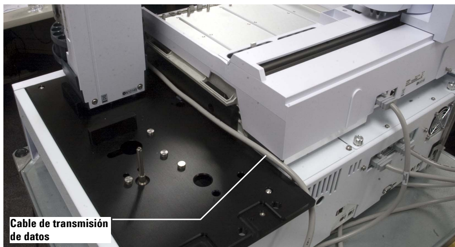
Figura 21 Colocación del cable en la torre delantera a lo largo del soporte de montaje de la bandeja de muestras.
