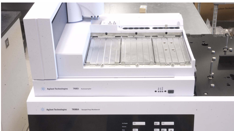
Figura 55 Bandeja de muestras con el módulo Peltier asentado de forma uniforme en la superficie de la estructura principal
