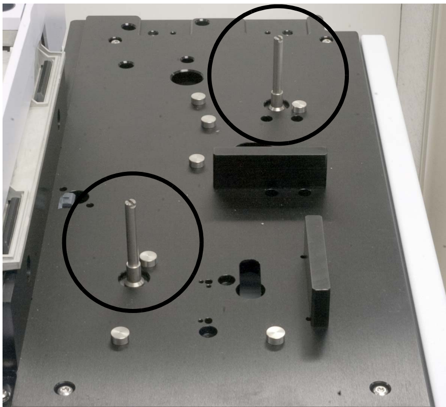
Figura 18 Instalación de los postes de montaje.
