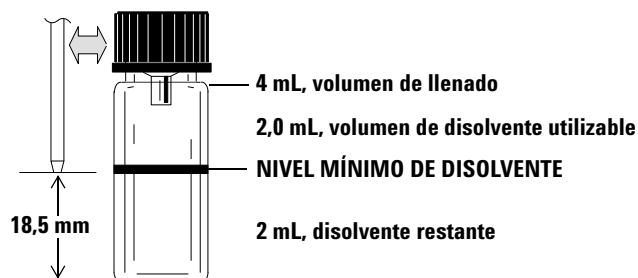
Figura 88 Posición de la punta de la aguja al extraer el disolvente
