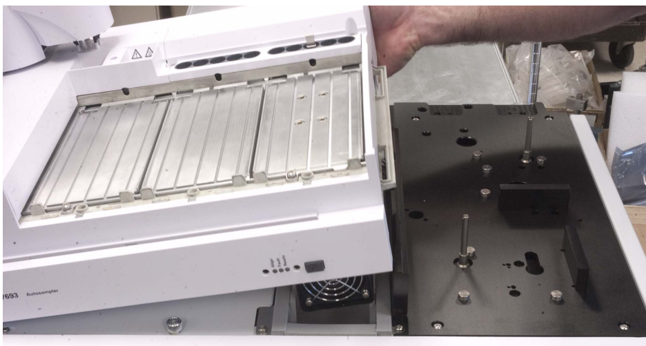
Figura 54 Colocación de la bandeja de muestras en el chasis de la estructura principal
