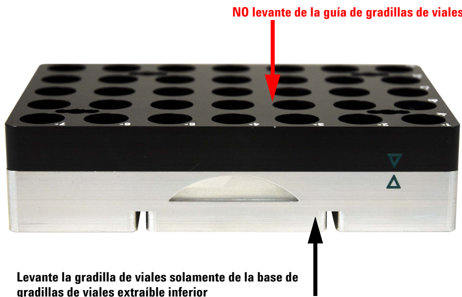
Figura 68 Levantar la gradilla de viales extraíble con la guía de gradillas
