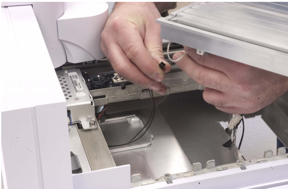
Figura 45 Conexión de los cables
