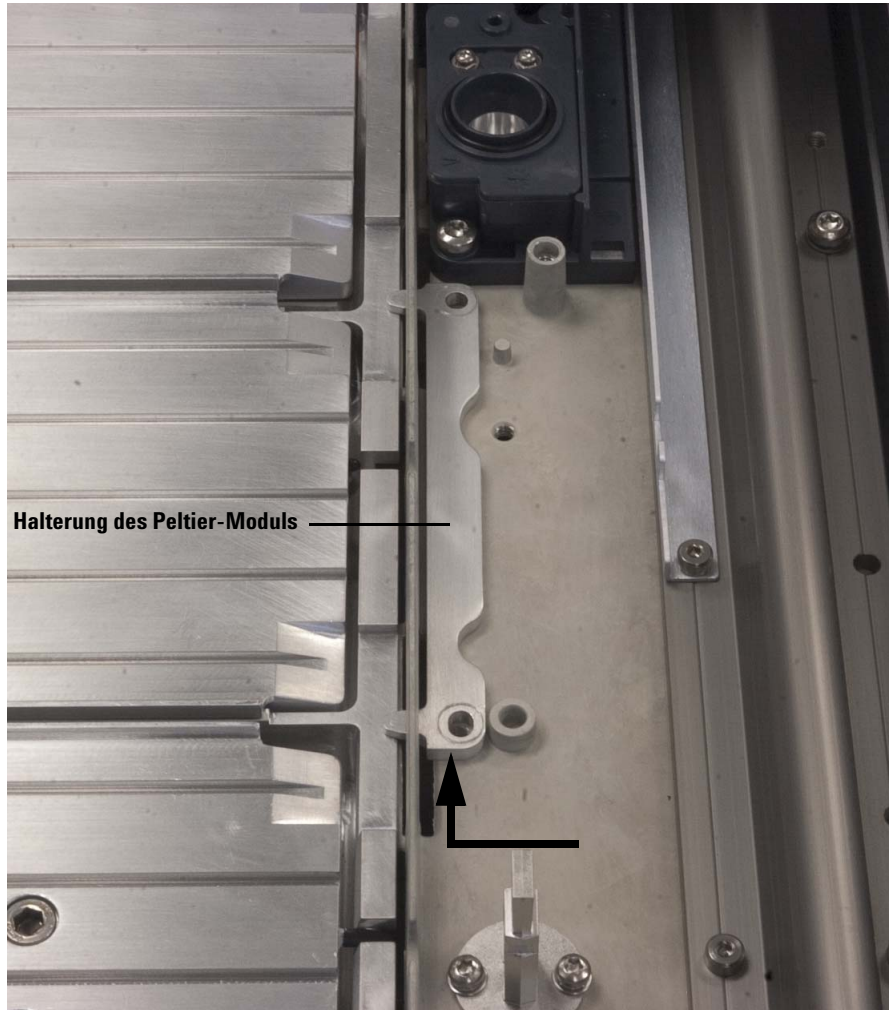
Abb. 49 Installieren der Halterung des Peltier-Moduls
