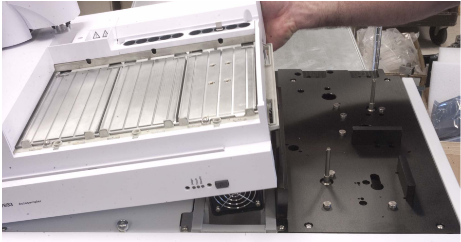
Abb. 54 Senken des Probentellers auf das Grundplattengehäuse
