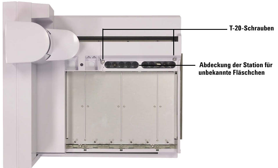
Abb. 39 Entfernen der Schrauben und der Abdeckung der Station für unbekannte Fläschchen
