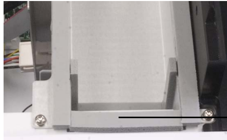
Abb. 35 Installation des Schaumstoffklebebands am Grundplattengehäuse
