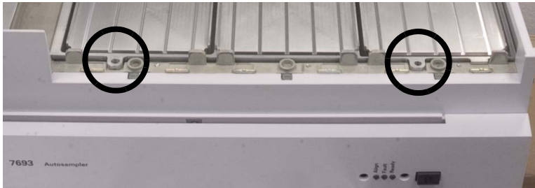
Abb. 48 Anbringen von zwei T-20-Torx-Schrauben zum Sichern der Vorderseite des Peltier-Moduls
