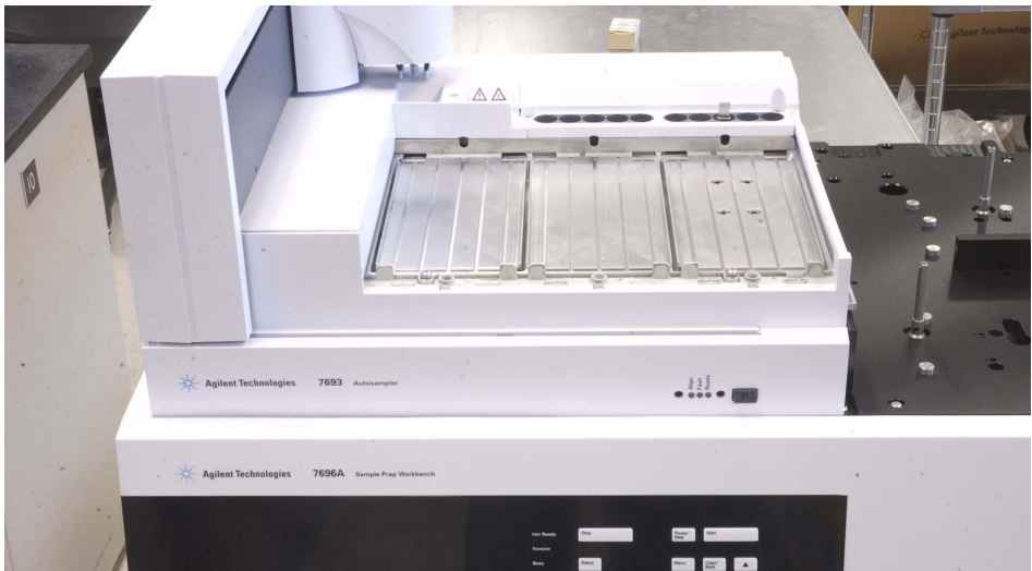
Abb. 55 Probenteller mit Peltier-Modul liegt gerade auf der Grundplattenoberfläche
