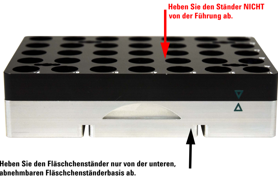
Abb. 68 Heben des abnehmbaren Fläschchenständers mit Führung
