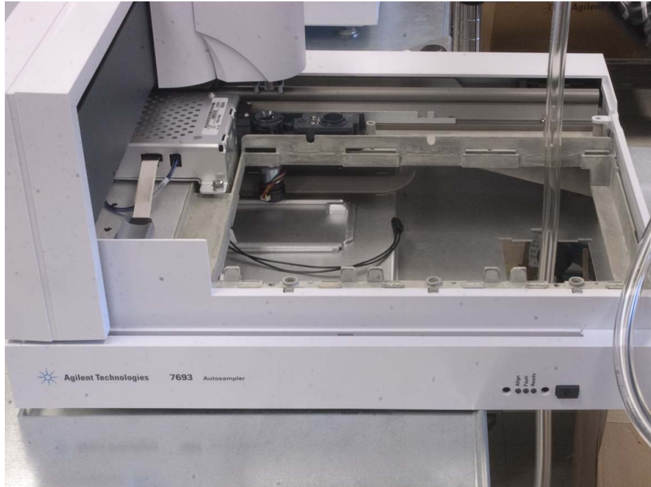
Abb. 44 Führen der Abflussleitung durch die Zubehöröffnung
