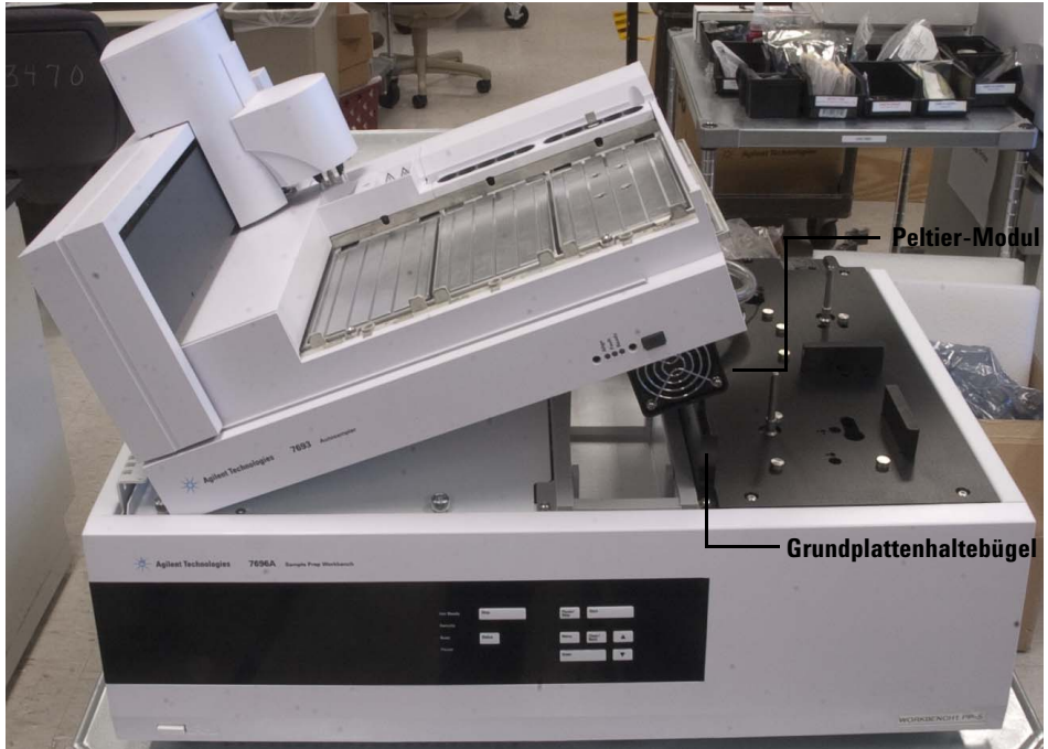
Abb. 52 Absetzen des Probenhalters auf der Grundplatte, wobei das Peltier-Modul auf dem Grundplattenhaltebügel ruht
