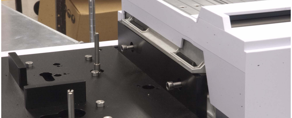
Abb. 57 Sichern des Probentellers am Grundplattenhaltebügel
