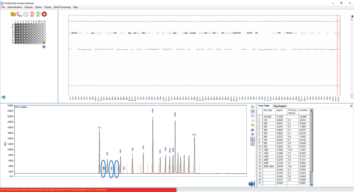
图 63 主界面上显示了未正确拟合的分子量校准（积分峰数量过多，蓝色圆圈）。纠正方法：增大最低峰高 (RFU) (Min. Peak Height (RFU)) 阈值，减少进行积分的峰
