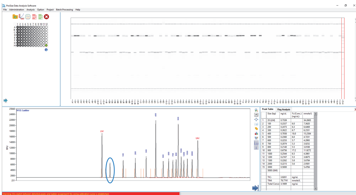
图 61 主界面上显示了未正确拟合的分子量校准（积分峰数量不够）。纠正方法：在 峰分析 (Peak Analysis) 表中，降低最低峰高 (RFU) (Min. Peak Height (RFU)) 阈值，对丢失的峰进行积分（蓝色圆圈）
