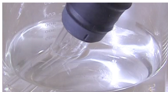
Figura 14. Immagine ravvicinata della torcia all'interno del recipiente; attenzione focalizzata sul livello di acido rispetto alla base in plastica.
