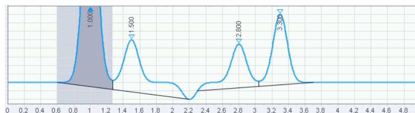
Рисунок 66 Интегрирование с построением базовой линии вручную между 2,3 и 3,6 min
