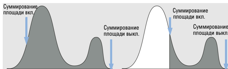
Рисунок 25 Событие Суммирование площади вкл. после вершины, но до конца пика
