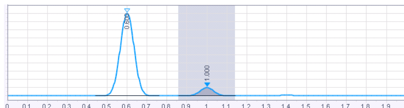
図 60 [最小ピーク面積] イベントによる積分
