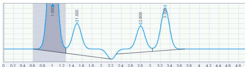
Figura 65 Integração com linha de base manual entre 2,3 e 3,6 min
