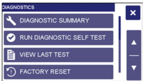
一連のプロンプトに従ってテストを実行します。セルフテスト診断には約 20 分かかります。実行中はポンプフローが停止し、プロセスの温度制御は行われません。
