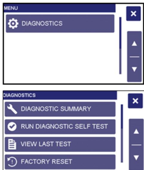
Eine Reihe von Bildschirmaufforderungen wird Sie dann durch das erforderliche Verfahren führen. Der Diagnose- Selbsttest dauert ca. 20 Minuten. Während dieser Zeit werden der Pumpenfluss und die Temperaturregelung der Anlage unterbrochen.
