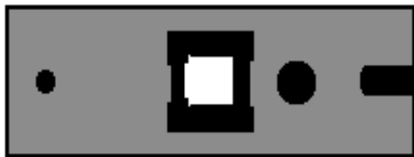
Figura 2. Vista superior del soporte para celdas con la sección ranurada colocada hacia la derecha.
