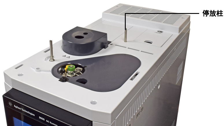
图 10 在 Intuvo 9000 GC 上安装停放柱
