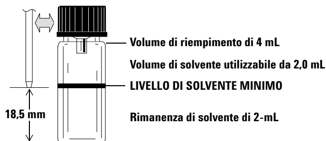
Figura 56 Posizione della punta dell'ago durante il prelievo di solvente
