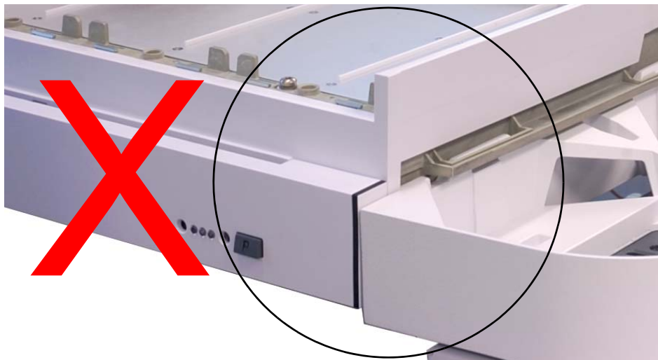
Figura 6 Vassoio per campioni installato in modo errato.
