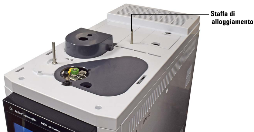
Figura 10 Installazione della staffa di alloggiamento su un GC 9000 Intuvo
