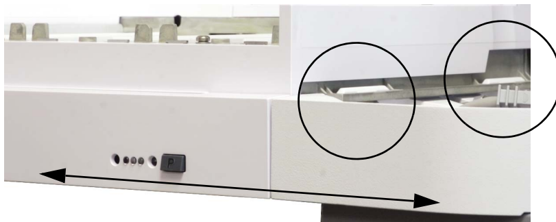
Figura 5 Vassoio per campioni correttamente installato.
