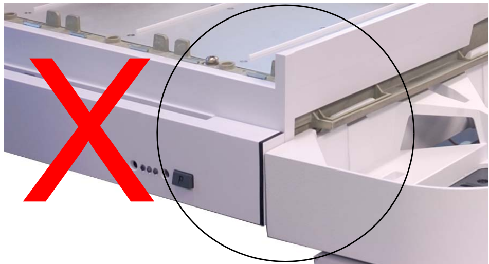
Figure 6 Porte-échantillons mal installé
