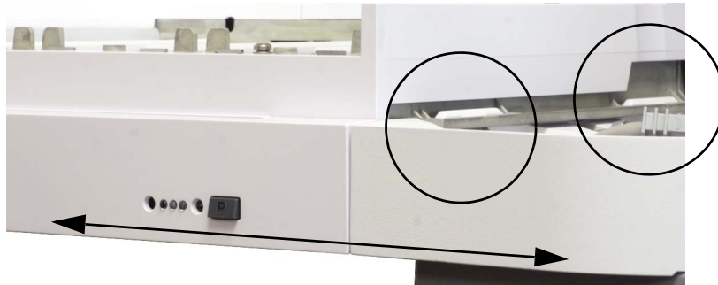
Figure 5 Porte-échantillons correctement installé
