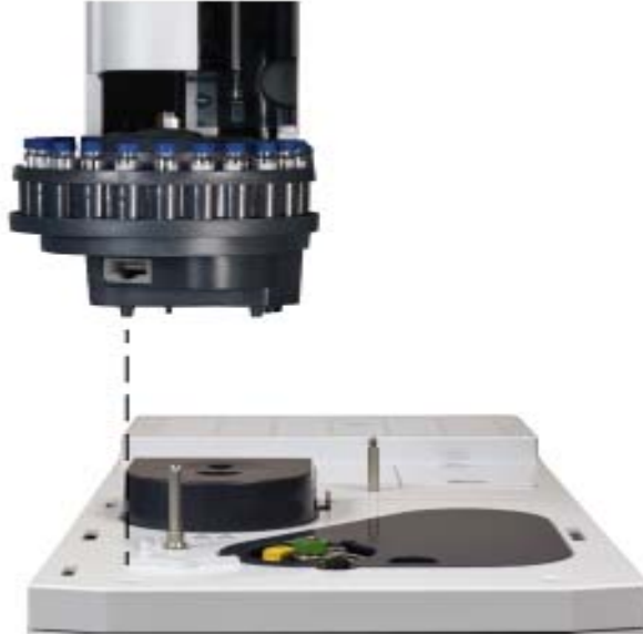
Figure 19 Montez l'injecteur sur le CPG Intuvo 9000.
