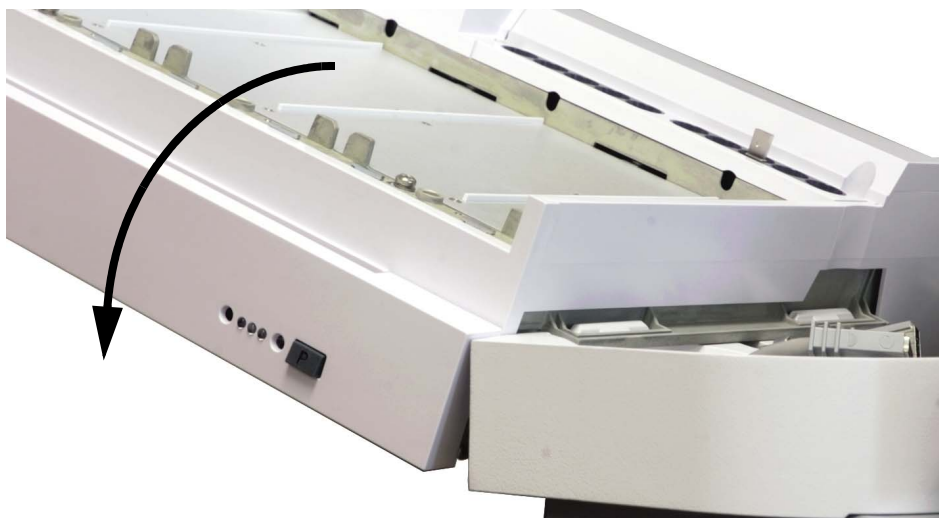
Figure 4 Mise en place du support du porte-échantillons au-dessus des pattes du support de montage
