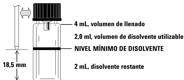
Figura 56 Posición de la punta de la aguja al extraer el disolvente
