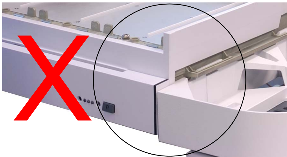
Figura 6 Bandeja de muestras instalada incorrectamente.
