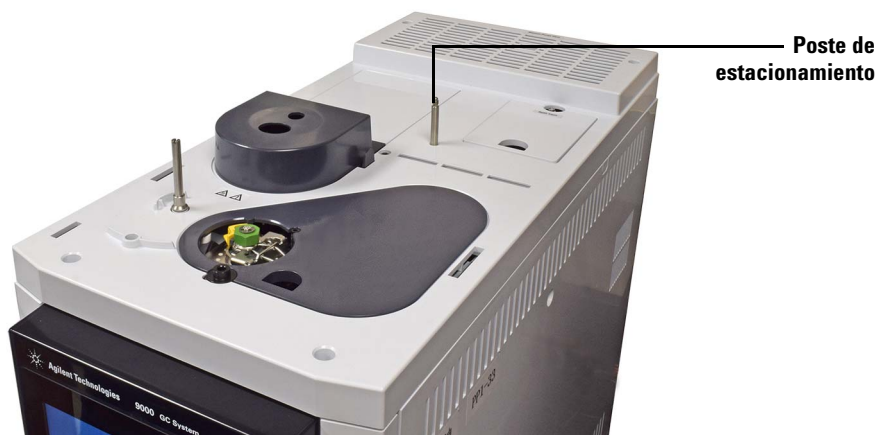
Figura 10 Instalación del poste de estacionamiento en un GC Intuvo 9000
