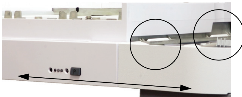
図 5 正しく取り付けられたサンプルトレイ
