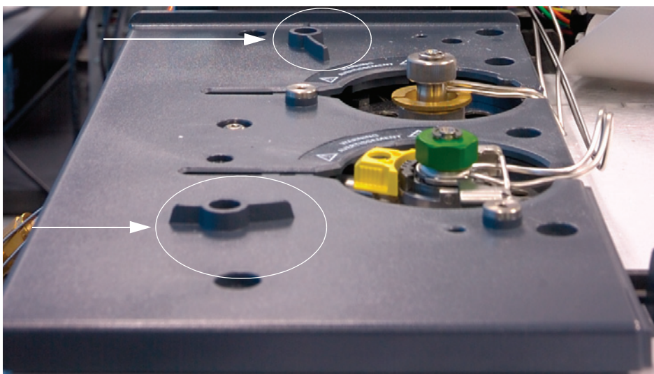
図1 適合性のある注入ポート上部カバーの特徴
