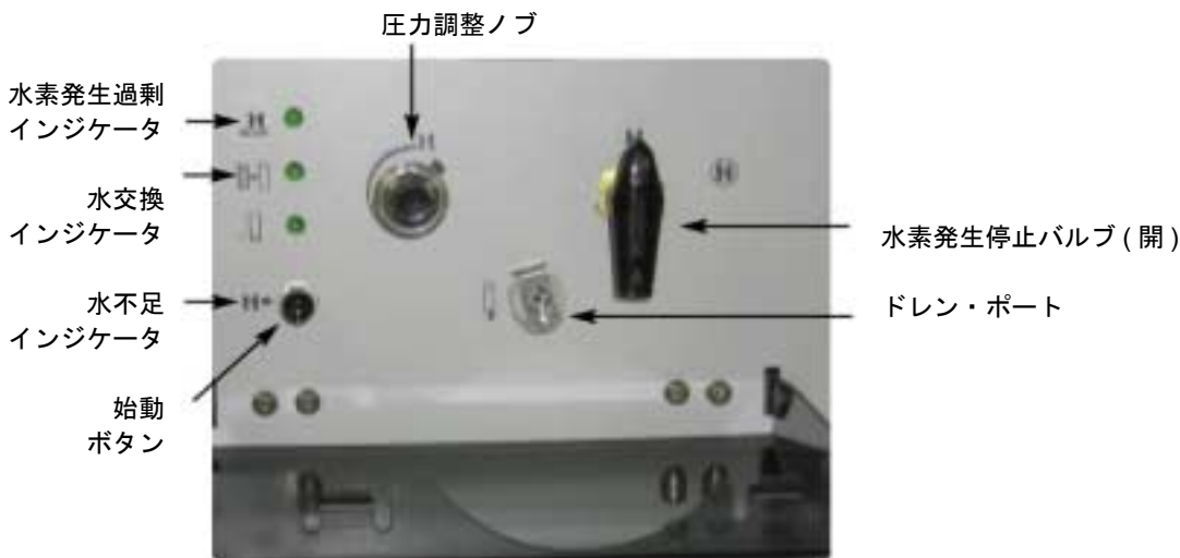
図8 操作部や故障表示灯はフロントのグレーのパネルの内側にあります。
