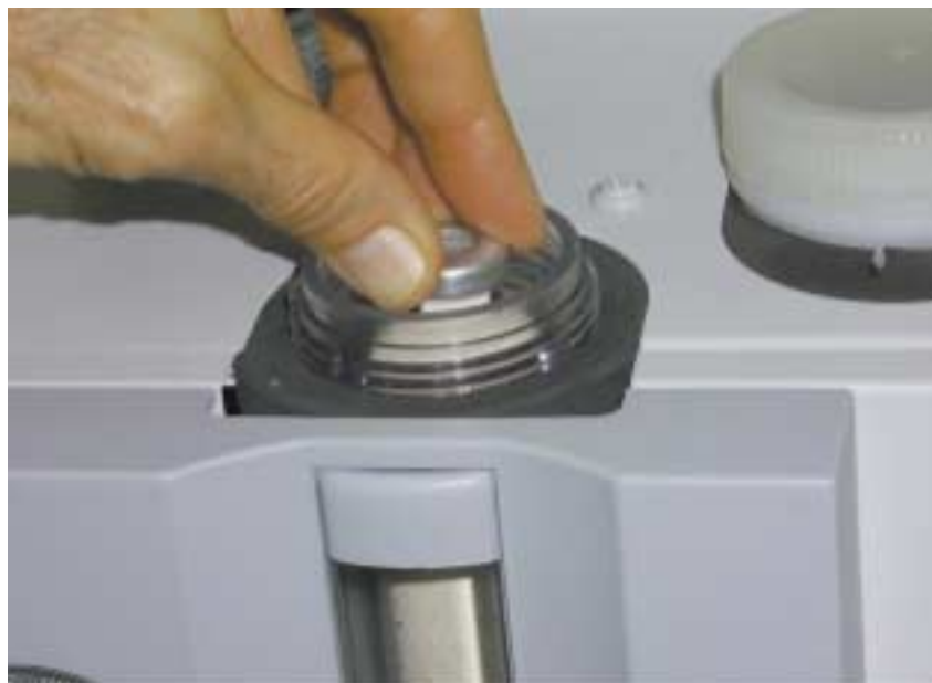
図 4 乾燥剤カートリッジの上部を しっかり押し下げて、ハウジン グ底部の O リングにはめこみ ます。
