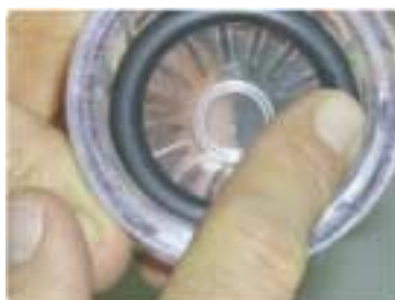
図 5 キャップを交換する際は O リン グがキャップの中心にあるか確認 します。
