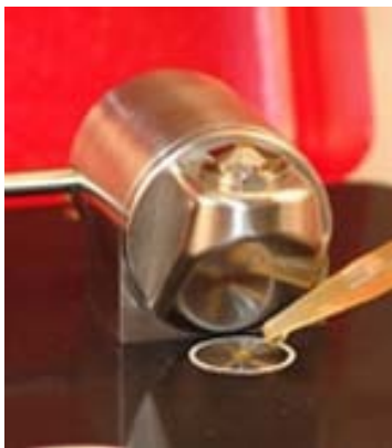
Figura 5. Cargar una muestra en el visor inferior del accesorio TumbIIR
