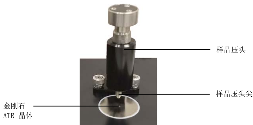
图 7. 样品压头在最高位置，以便进行样品滴入和清洁
