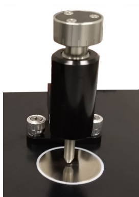
图 8. 样品压头降低以进行分析
