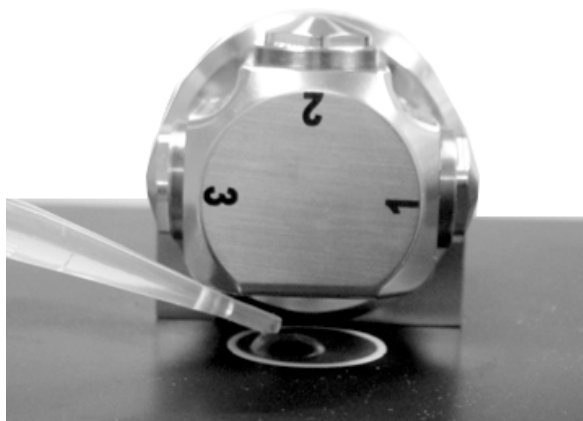
图 13. 将样品放在 Dialpath 液体分析附件底部窗上
