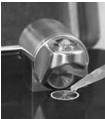
图 6. 将样品放到 TumbIIR 液体分析附件的底部窗
