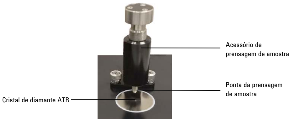
Figura 7. Acessório de prensagem da amostra na posição mais alta, permitindo fácil acesso para o carregamento e limpeza de amostra
