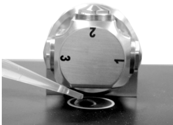
Figura 13. Aplicação de uma amostra na janela da parte de baixo da DialPath
